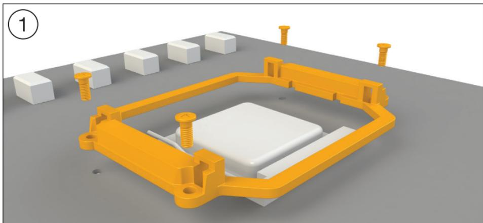
**Assemblage du cadre de montage du ventilateur**
