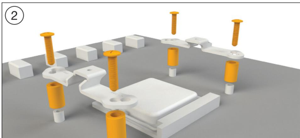
Placez les quatre boulons d'écartement AMD (8) sur les filetages de la plaque arrière, sur la façade avant, et fixez les deux ponts de montage AMD (5) à l'aide des vis de la plaque arrière AMD (11).
