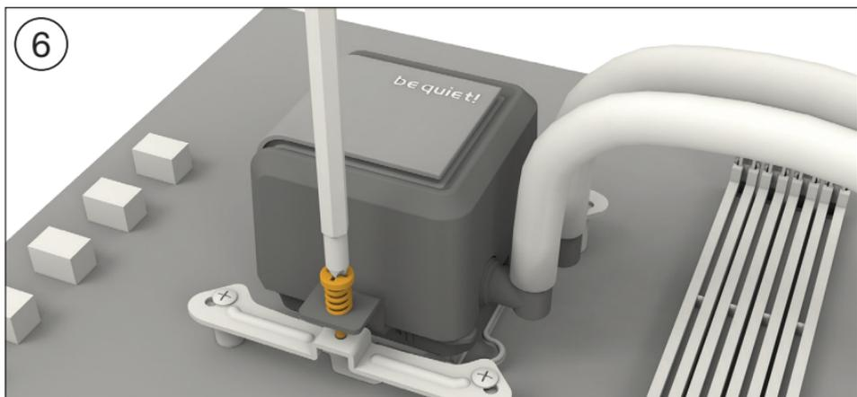
Placez le bloc CPU au centre des ponts de montage Intel (4) de manière à ce que ceux-ci permettent de visser le bloc CPU. Vous pouvez utiliser à cet effet un tournevis cruciforme ordinaire.
