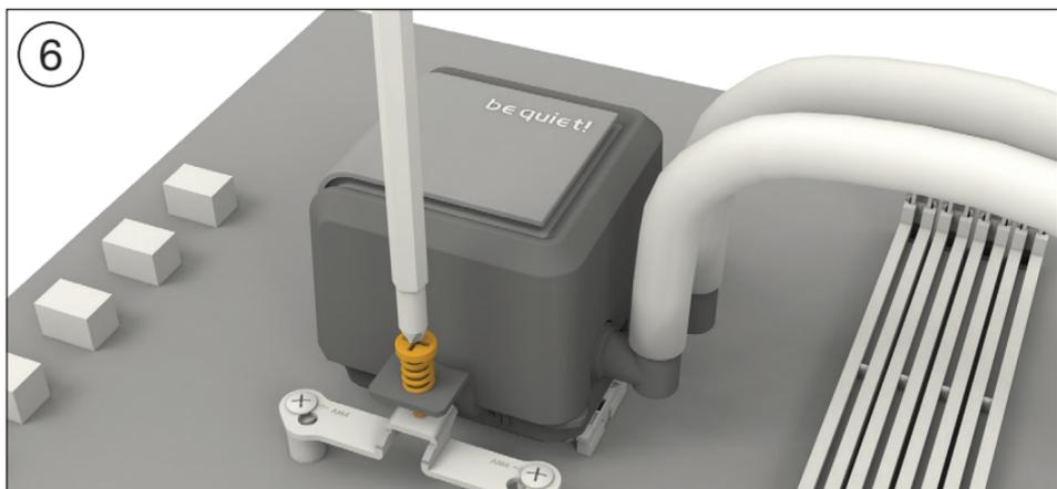
Placez le bloc CPU au centre des ponts de montage Intel (5) de manière à ce que ceux-ci permettent de visser le bloc CPU. Vous pouvez utiliser à cet effet un tournevis cruciforme ordinaire.
