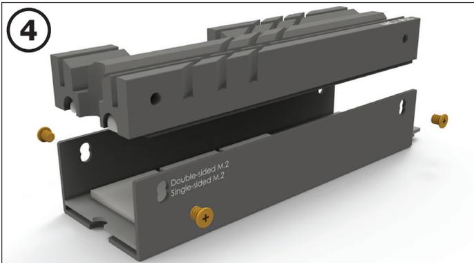
Placez le refroidisseur M.2 (1) sur le lecteur. Ensuite, serrez fermement les vis M2 (3) pour relier le refroidisseur (1) à la plaque arrière du refroidisseur (2). Poussez doucement le refroidisseur M.2 (1) pour faciliter le processus.
