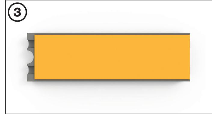
Retirez le revêtement protecteur du coussin thermique de la face supérieure du refroidisseur M.2 (1).
