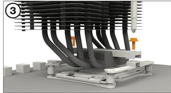
Positionnez le pont de fixation du refroidisseur (6) au centre du ventirad (1). Ensuite, placez l'unité de refroidissement (1) sur le processeur. Insérer les vis de fixation du pont de montage Intel (11) par le haut dans le pont de montage du refroidisseur, puis vissez les alternativement au maximum.
