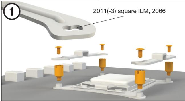
**Assemblage du cadre de montage du refroidisseur**
