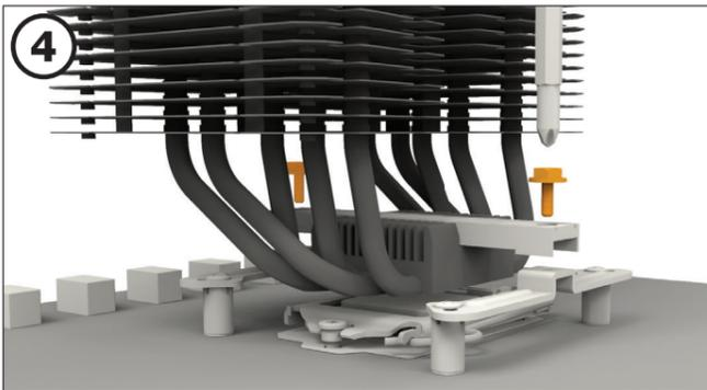
Positionnez le pont de fixation du refroidisseur (6) au centre du ventirad. Ensuite, placez l'unité de refroidissement (1) sur le processeur. Insérer les vis de fixation du pont de montage (11) par le haut dans le support de montage du refroidisseur (6), puis vissez les alternativement. Vous pouvez utiliser le tournevis cruciforme (18) pour cela.
