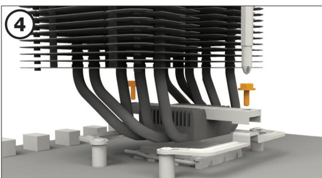
Positionnez le support de montage du refroidisseur (6) au centre du ventirad. Ensuite, placez l'unité de refroidissement (1) sur le processeur. Insérer les vis de fixation du support de montage Intel / AMD (11) par le haut dans le pont de fixation du refroidisseur (6), puis vissez les alternativement. Vous pouvez utiliser le tournevis cruciforme (18) pour cela.
