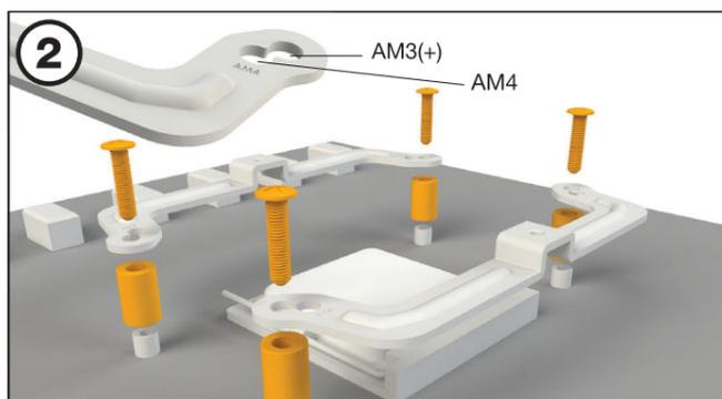
Placer les écrous-entretoises 4x AMD (9) sur les boulons de la plaque arrière sur le côté avant et fixer les deux supports courts de montage AMD (5) avec les vis pour la plaque arrière AMD (13).
