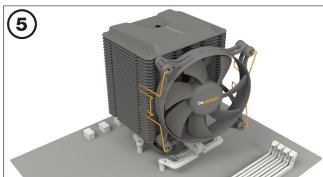
Fixez le ventilateur de 120 mm (2) sur l'unité de refroidissement (1) à l'aide des clips de fixation pour ventilateur (15). Connectez le ventilateur au signal PWM de la carte mère.
