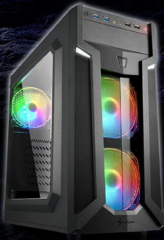
Le VG6-W RGB est certifié pour l'Asus Aura Sync, la MSI Mystic Light Sync, la Gigabyte Fusion et la plupart des autres acteurs majeurs du marché avec la disposition des pins correspondantes. Il est donc facilement incorporable dans les systèmes existants.
